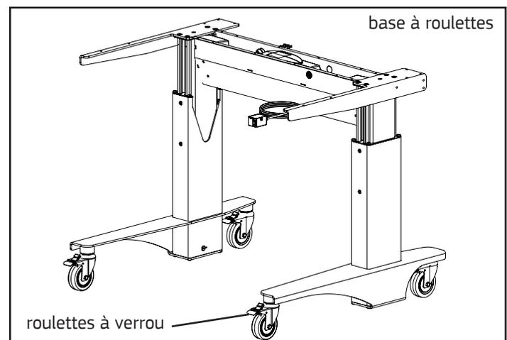
1. Pour les bases à glissement (ci-dessus à gauche), équilibrez la base en ajustant les quatre glissières placées sous les pieds de la base. Pour les bases à roulettes, (ci-dessus à droite), bloquez les verrous de roulette lorsque la base est utilisée.
