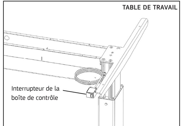
3. Branchez l'unité dans une prise de terre de 120 volts. Régler la hauteur de la base en appuyant sur le bouton blanc de la boîte de contrôle indiquant up/down
